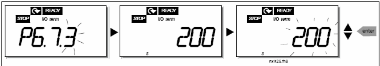
图 7-14. HMI 确认超时时间
