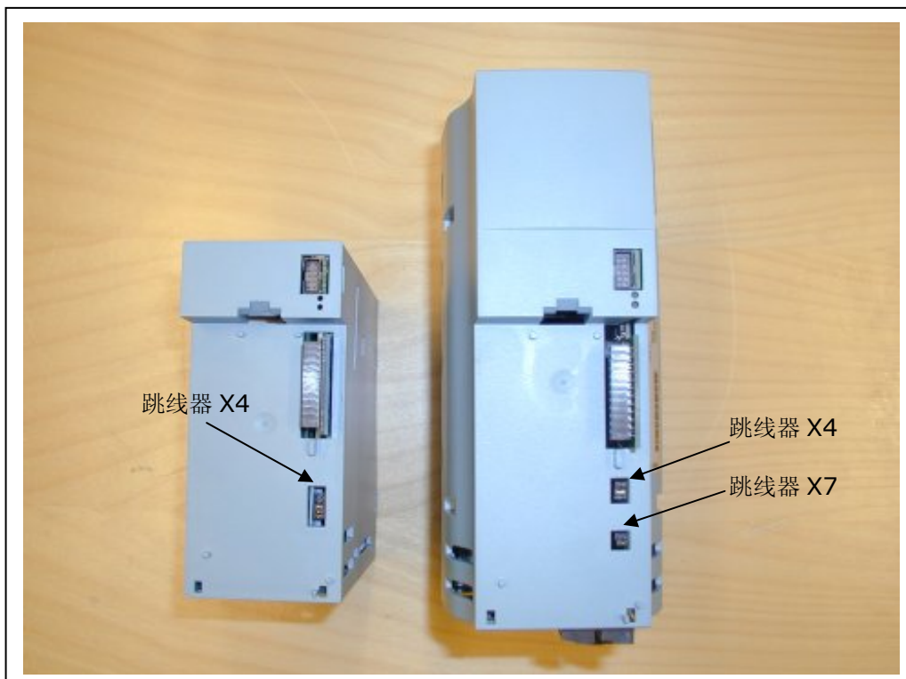
图 6-26. MF2(左)和 MF3(右)变频器的跳线器位置
