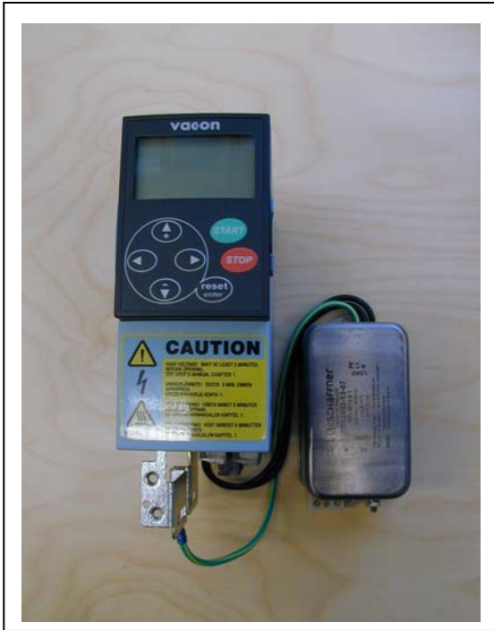
图 6-13. MF2 安装 RFI-0012-2-1 滤波器
